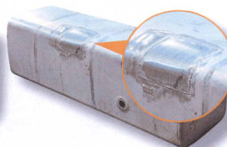
Réservoir réparé Tank repaired
