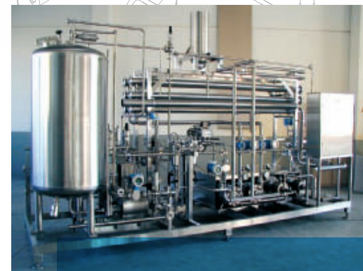
Umkehrosmoseanlage 3,8" in Werkstoff 1.4404 (316L) in der Milchverarbeitung 3.8" Reverse osmosis plant for the dairy industry, material: 1.4404 (316L)
