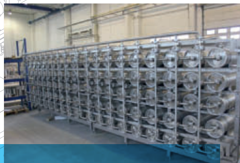
Druckrohr rack mit Verrohrung für die Getränkeindustrie Membrane rack with collectors for the beverage industry
