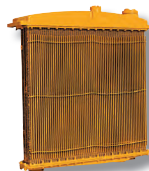
Radiateur Caterpillar rénové
